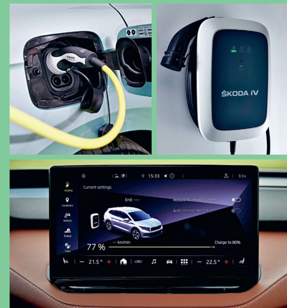
Auffaden: Ein Typ-2-Ladekabel (AC) gehört immer ins Auto; über die Wallbox ŠKODA iV-Charger lässt sich die Batterie zu Hause schnell und bequem laden. Das Touchscreen-Display zeigt den Ladezustand des ENYAQ iV.
