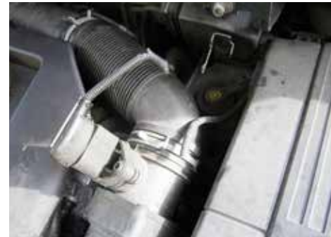
Beschädigung durch Nagetiere
