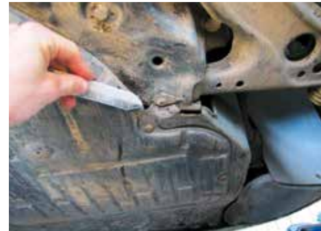
Beschädigung der Unterbodenverkleidung
