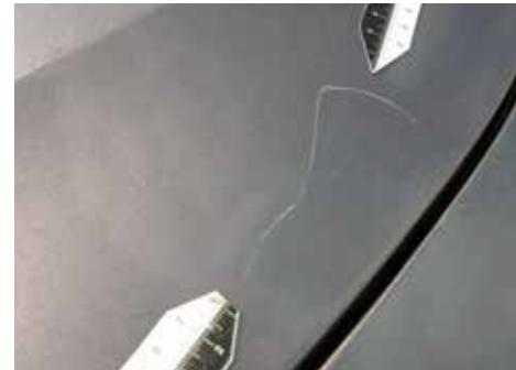
Beschädigung des Basislacks
