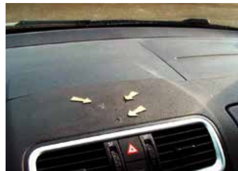
Bohrlöcher im Verkleidungsteil
