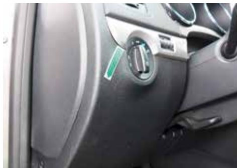
Geringfügige Beschädigung der Kunststoffverkleidung
